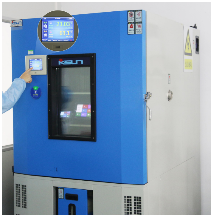
图 5-3 高低温老化测试图
