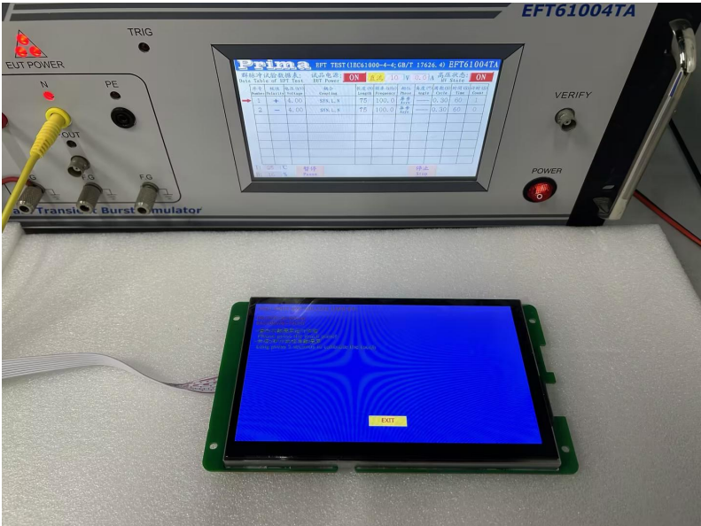
图 5-4 群脉冲测试图
